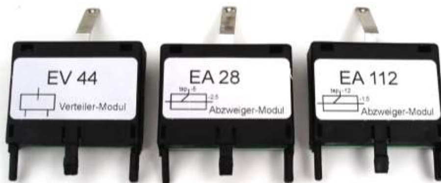
Abbildung 1: Eingangsverteiler EV44, Eingangsabzweiger EA28 und EA112
