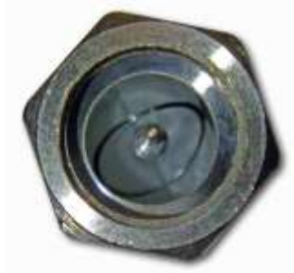
Abbildung 2: Adapter BNC-FM (ohne Mutter) mit Metallspan
