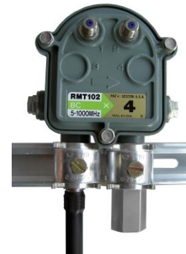
Abbildung 3: Anwendungsbeispiel mit Jumperkabel JK200 am Eingang
