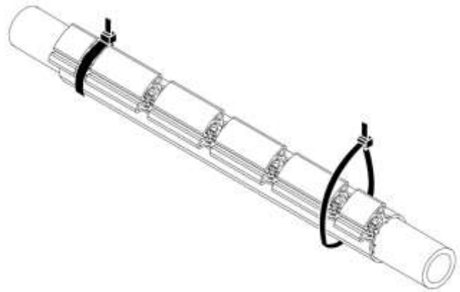
Abbildung 6: „Sicherung mit Kabelbindern“
