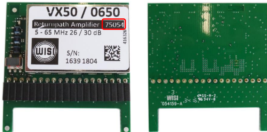
Abbildung 1: Aktuelle Version VX50/0650 75054 mit 3. Modifikation (Stand Oktober 2016)
