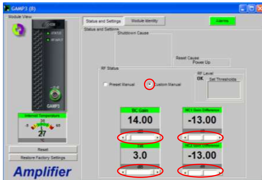
Abbildung 4 : Pegeleinstellung für Empfänger Rx A und Rx B
